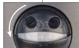
Réglage du SENSOR sous le capot de la cellule de détection
